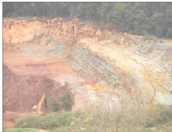
Slika 9. Iskop boksita bagerom s hidrauličkim čekićem
