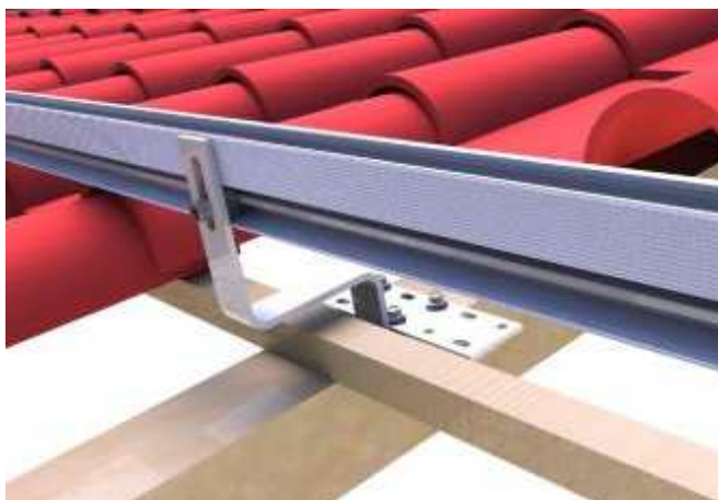
Slika 3.1. Potkonstrukcija FN modula
