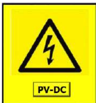
Slika 5.1. Označavanje trase kabela istosmjerne struje unutar građevine
