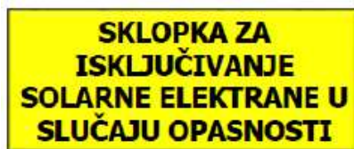
Slika 5.2. Označavanje sklopke za isključivanje elektrane
