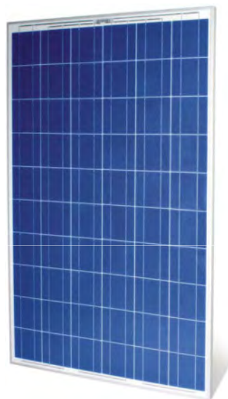
SV60 60 ćelije 1663x998 mm 215-245 W
