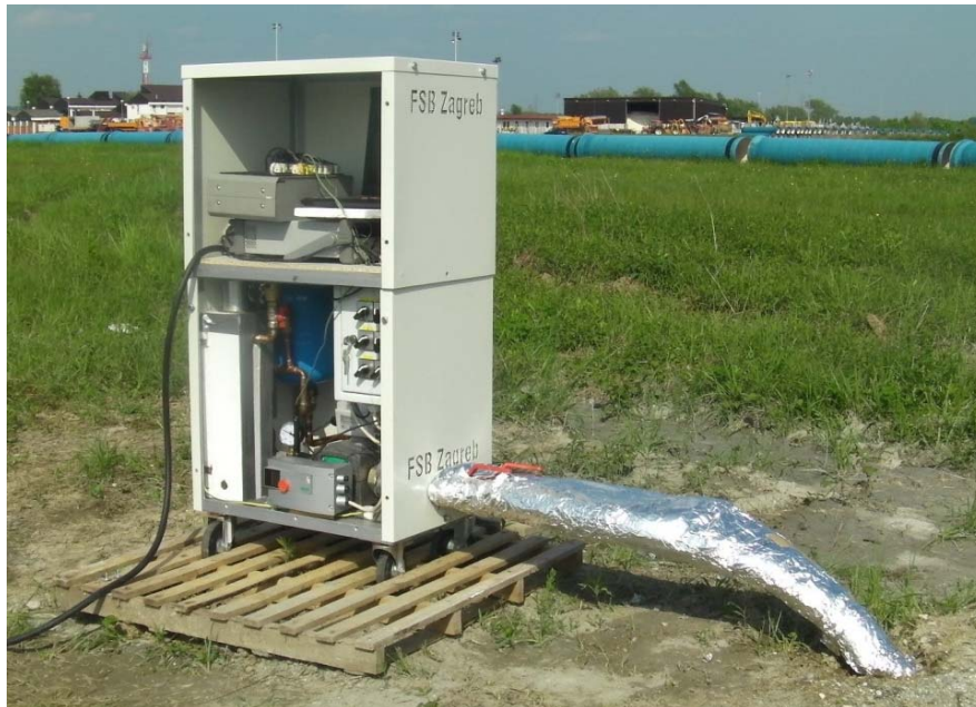
Test termičkog odziva tla (TRT) na lokaciji Rugvica
