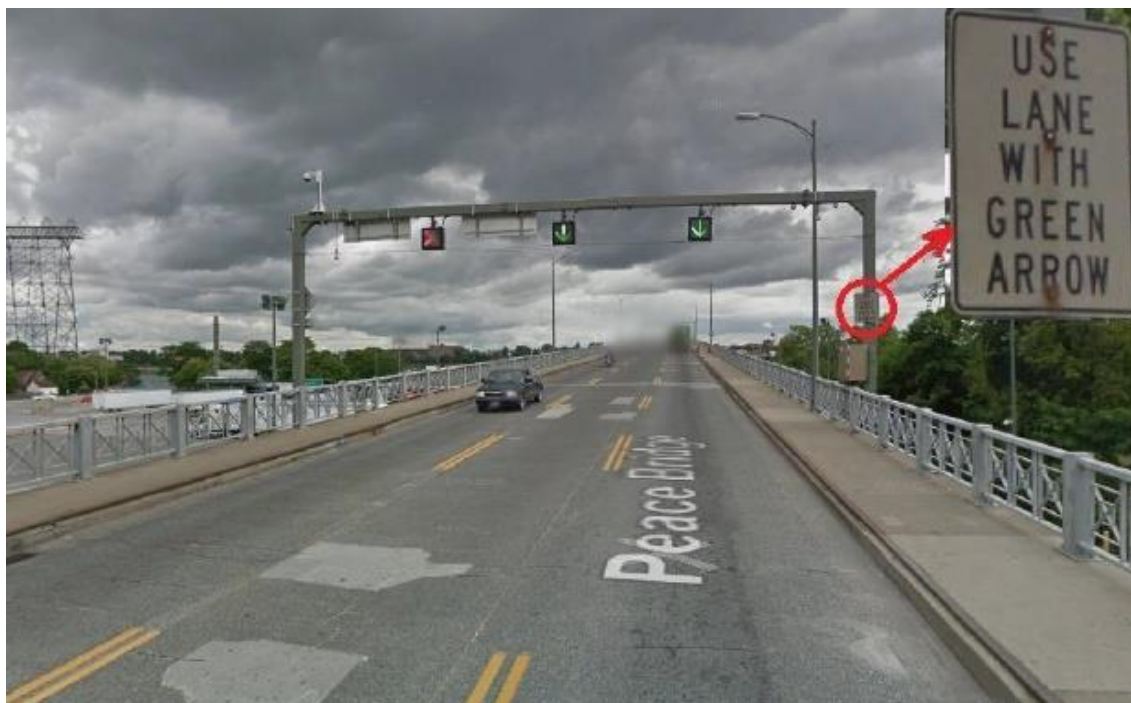
Fotografija 26. Prikaz mogućnosti korištenja svjetlosne signalizacije za promjenjivo usmjerenje prometnih traka
