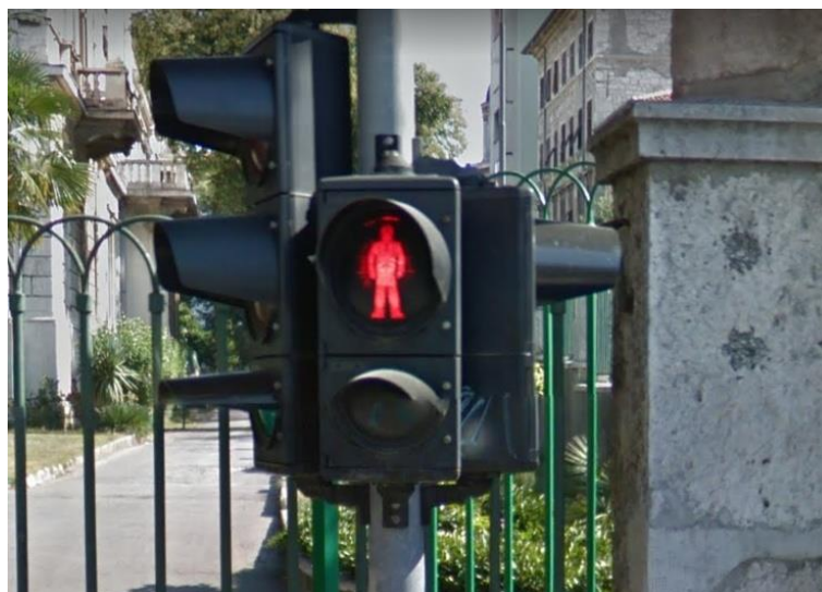
Fotografija 22. Semafora lanterna sa zastarjelim halogenim izvorom svjetlosti
