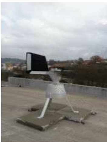
Slika 2. Aparat za uzorkovanje peludi
